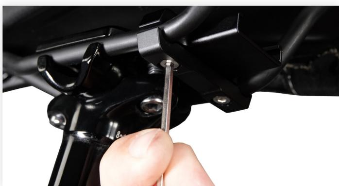
**2.** Den unteren Teil des Halters anlegen und mit den beiliegenden Schrauben fixieren (3 Nm). **Wichtig:** Die beiden Schrauben nur soweit hinein drehen, dass sie das C14 MAG später nicht berühren. Die beiliegenden, längeren Schrauben sind ausschließlich zur Befestigung des C14 MAG an Carbon Sätteln gedacht.
