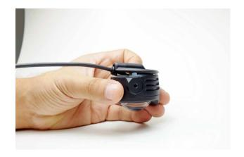
Befestigen Sie das Endcap wieder an der Rückseite der SL. (Max. Drehmoment: 1 Nm)
