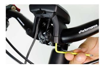
Entfernen Sie zuerst einen der bestehenden Bosch Halterarme und die beiden Schrauben.
