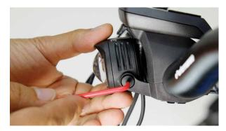
Schrauben Sie nun die SL an den beiden Halterungen am Bosch Display fest. Verwenden Sie dazu die mitgelieferten Halterschrauben und einen TL5 Torx.
