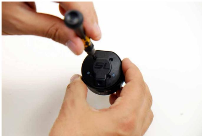
3. Entfernen Sie das Endcap mit den vier Schrauben an der Rückseite der Lampe.
