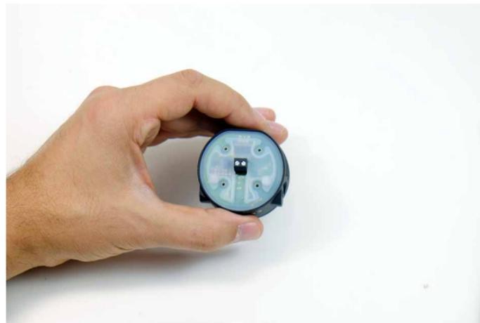
4. Achten Sie darauf, dass die transparente Dichtung korrekt auf der Platine im Lampengehäuse sitzt. (siehe Bild)
