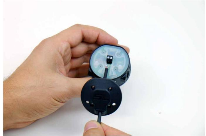
6. Bevor Sie das Lichtkabel mit der SL verbinden, fädeln Sie bitte das Endcap auf das Lichtkabel auf. Positionieren Sie nun die beiden Kabellitzen in die Kabelklemmen und schrauben diese fest.
