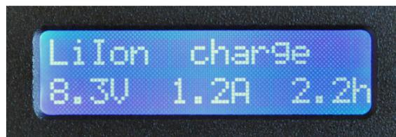
Lassen Sie den Akku solange am Ladegerät hängen, bis in der ersten Zeile des Displays "Li-Ion full" oder "Li-Ion puls" erscheint.
