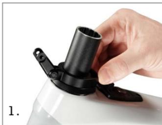
1. Führe den Spacer über den Gabelschaft. Montiere anschließend die Lenkereinheit nach den Vorgaben des Herstellers.
