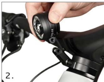
2. Befestige nun den Lampenkopf am Halter, indem du die beiden TX15 Schrauben auf beiden Seiten anziehst.
