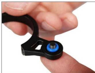
2. Befestige die obere Halterschelle mit Hilfe des beiliegenden 3er Sechskantschlüssel am Lampenkopf. (2Nm)
