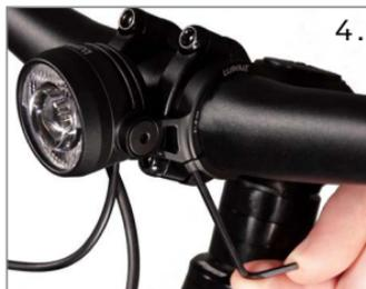
4. Richte die Lampe mit Halter vorsichtig aus und schraube sie mit dem beiliegenden 2,5er Sechskantschlüssel mit maximal 1Nm fest.
