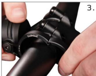
3. Positioniere die Lampe und die obere Halterschelle an der linken Seite des Vorbaus. Führe dann die zwei Hälften des Halters zusammen.
