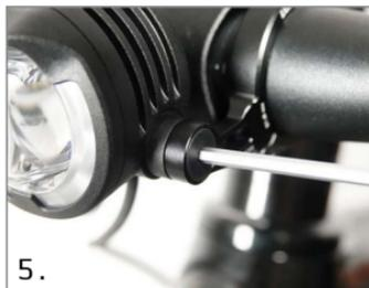
5. Schraube den Bolzen bis zum Anschlag in das Gewinde des Lampenkopfes.
