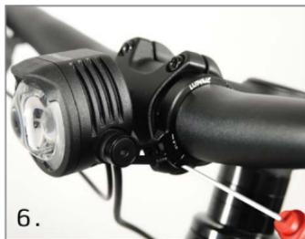
6. Löse die Schraube des Halters leicht, richte die Lampe mit Halter vorsichtig aus und schraube sie erneut mit maximal 0.5Nm fest.
