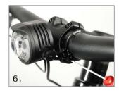
Löse die Schraube des Halters leicht, richte die Lampe mit Halter vorsichtig aus und schraube sie erneut mit maximal 0.5Nm fest.
