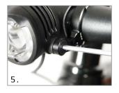
5. Schraube den Bolzen bis zum Anschlag in das Gewinde des Lampenkopfes. Der Halter sollte möglichst nah am Vorbau anliegen. Die Nuten der Verbindungsstelle müssen bündig ineinandergreifen. Der Lampenkopf sollte möglichst zentriert und nah vor dem Vorbau befestigt sein.
