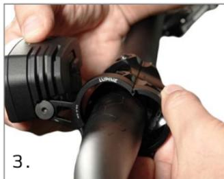
3. Positioniere die Lampe und die obere Halterschelle auf der gewünschten Seite des Vorbaus. Führe dann die zwei Hälften des Halters zusammen.
