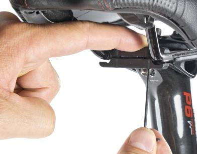
Das Rotlicht kann nun von unten in den Halter eingeschoben werden. Achtung! Das Einschieben muss ohne große Kraftaufwendung geschehen. Wenn es nicht leichtgäng einklickt ist der Halter falsch montiert.
