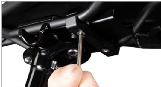
2. Die untere Schelle anlegen und mit den beiliegenden Schrauben fixieren. Wichtig: Die beiden Schrauben nur soweit hinein drehen, dass sie das C14 MAG später nicht berühren.
