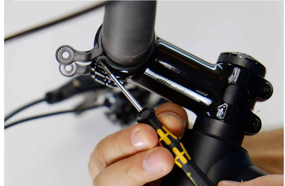
2. Schrauben Sie die beiden Halterarme an dem Lenker fest.
