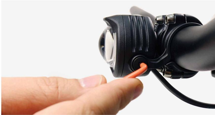
3. Schrauben Sie nun die SL an den beiden Halterungen am Vorbau fest. Verwenden Sie dazu die mitgelieferten Halterschrauben und einen T15 Torx.
