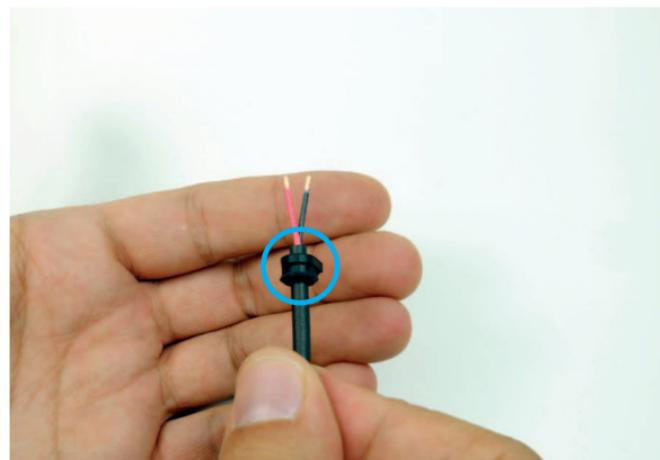
3. Längen (2 cm) und isolieren (3-4 mm) Sie das Original Bosch Lichtkabel ab.
