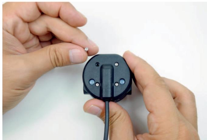
2. Entfernen Sie das Endcap mit den vier Schrauben an der Rückseite der Lampe.
