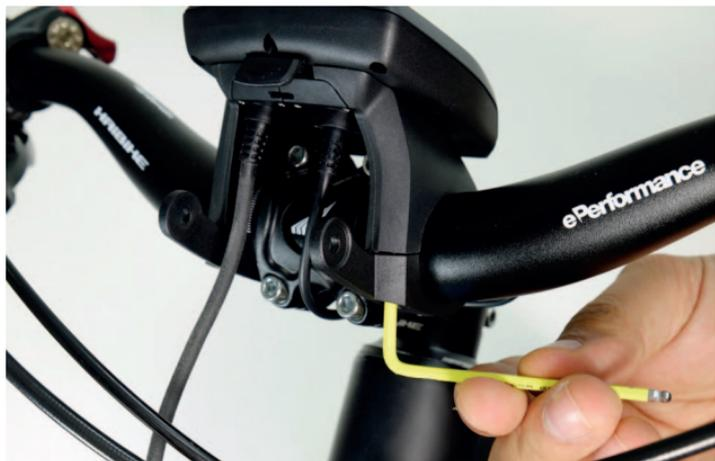
1. Entfernen Sie zuerst einen der bestehenden Bosch Halterarme und die beiden Schrauben.
