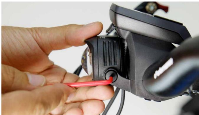
7. Schrauben Sie nun die SL an den beiden Halterungen am Bosch Display fest. Verwenden Sie dazu die mitgelieferten Halterschrauben und einen T15 Torx.
