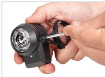
Anschließend kann der Schnellspanner mit dem beiliegenden Sechskantschlüssel montiert werden.
