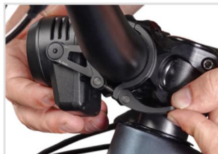
Die Lampe mittig am Lenker montieren und die Schelle des Schnellspanners schließen.
