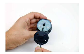
6. Bevor Sie das Lichtkabel mit der SL verbinden, f\u00e4deln Sie bitte das Endcap auf das Lichtkabel auf. Positionieren Sie nun die beiden Kabellitzen in die Kabelklemmen und schrauben diese fest.
