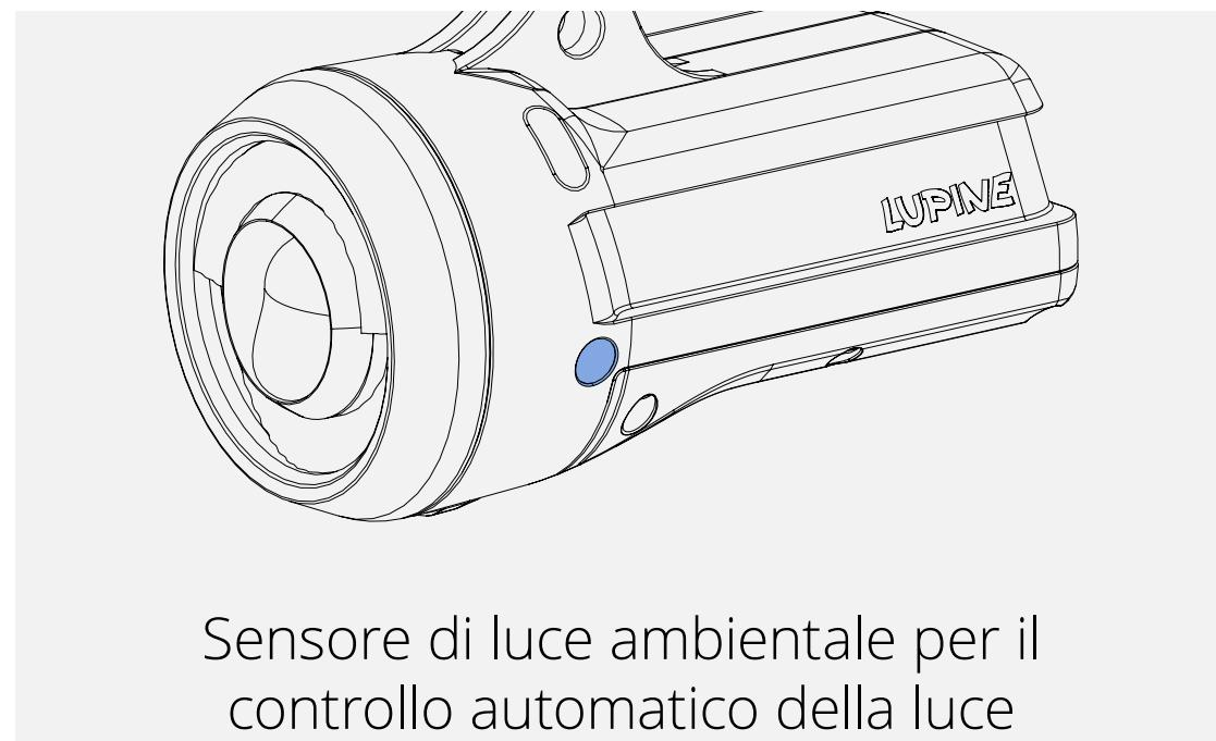
Sensore di luce ambientale per il controllo automatico della luce
